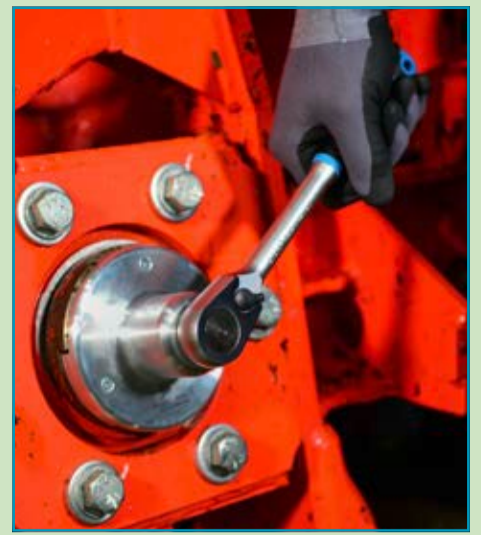
Manövrering med spärrnyckel med insatt 1/2" (12,5 mm) 4-kantshållare
